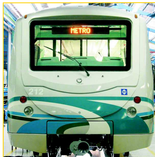
Foto Ilustrativa do Indicador de Destino instalado no novo trem do Metrô de São Paulo (Ano / 2009)
